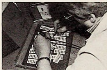
8. Tussentijdse steekproefmetingen aan weerstandsplaatjes.
