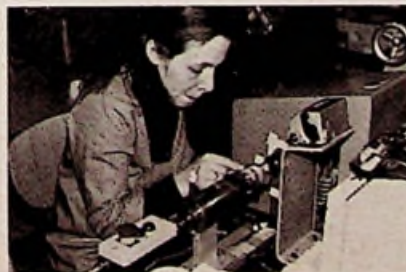
14. Ook de eindafwerking van de voedingstransformator is nog handwerk.
