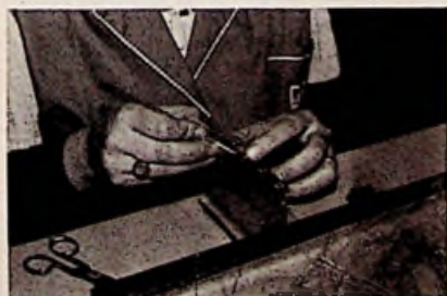
10. Het bedraden van modules voor het ingieten.
