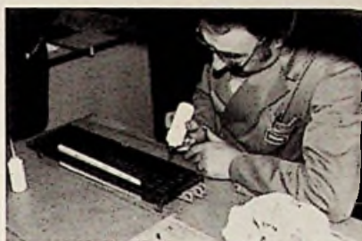
11. Met hardbare vulmassa worden de componenten in de omhullingen ingegoten.
