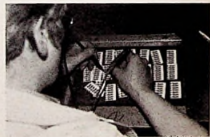
5. Na het verharden volgt de eerste weerstandstest.
